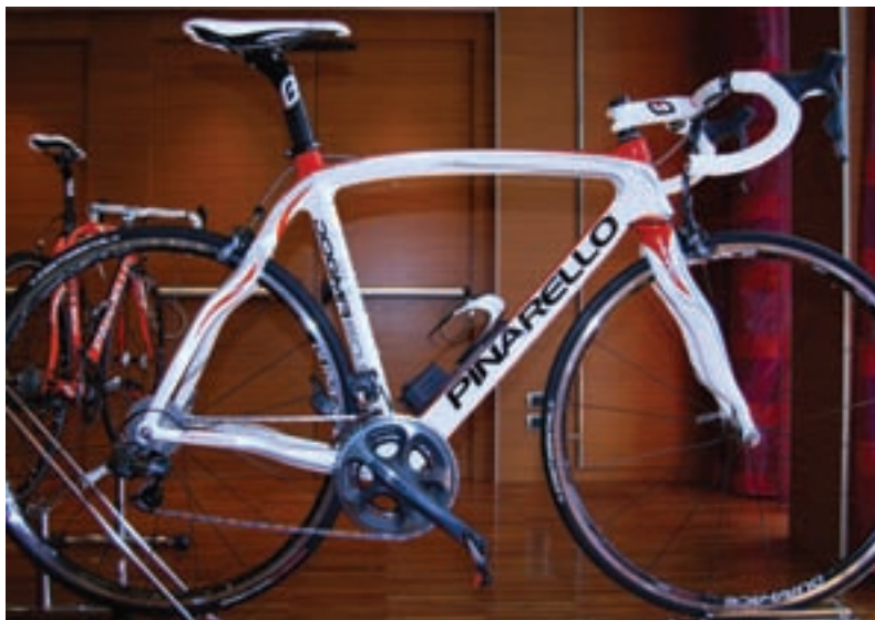
Okvir je na voljo tudi z notranjo napeljavo kablov skupine Dura Ace Di2
